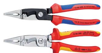
**Beschreibung:** Multi-Installationszange mit Greifzonen für Flach- und Rundmaterial, zum Biegen, Entgraten, Kabelschneiden von Kupferkabel bis Ø 15 mm (5 x 2,5 mm<sup>2</sup>), Abisolieren von Einzeladern (0,75 mm<sup>2</sup>, 1,5 mm<sup>2</sup> und 2,5 mm<sup>2</sup>) und Crimpen von Aderendhülsen (0,5 mm<sup>2</sup> bis 2,5 mm<sup>2</sup>).
